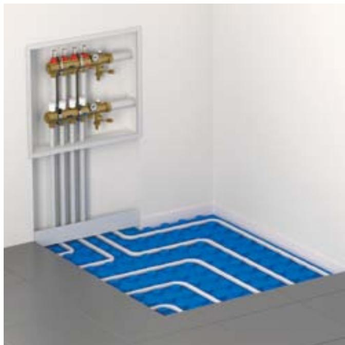
Impianto radiante realizzato con tubo multistrato Mixal
