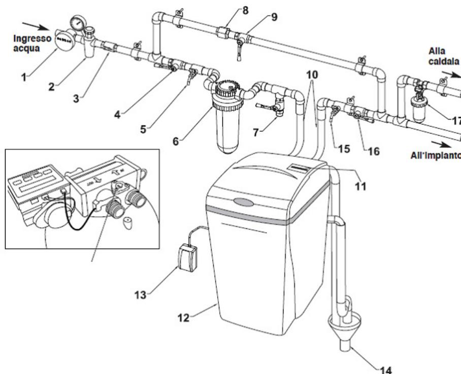
1. Contatore 2. Riduttore di pressione 3. Valvola non ritorno 4. Valvola intercettazione a monte 5. Rubinetto prelievo acqua grezza 6. Filtro di sicurezza 7. Derivazione acqua filtrata per altri usi 8. Raccordo a bocchettone 9. Rubinetto by-pass 10. Raccordi flessibili 11. Display timer 12. Cabinato 13. Alimentatore 14. Scarico 15. Rubinetto prelievo acqua addolcita 16. Valvola intercettazione a valle 17. Dosatore anticalcare 18. Valvola miscelatrice NB. Il modello MINI ha gli attacchi laterali
